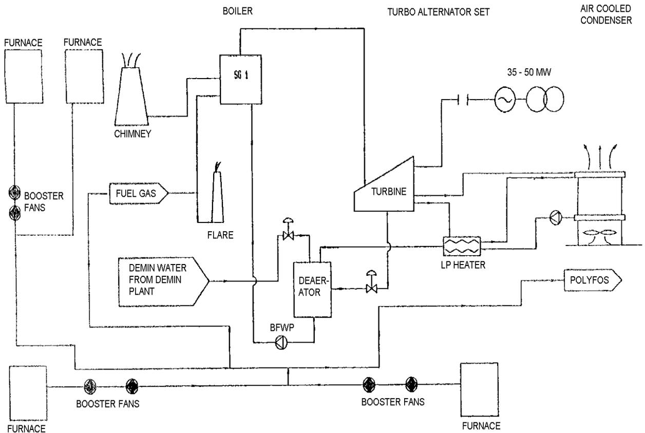
**FIGURE 1 - STEAM & CONDENSATE SYSTEM**
